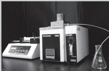
光反応+フローマイクロ装置
